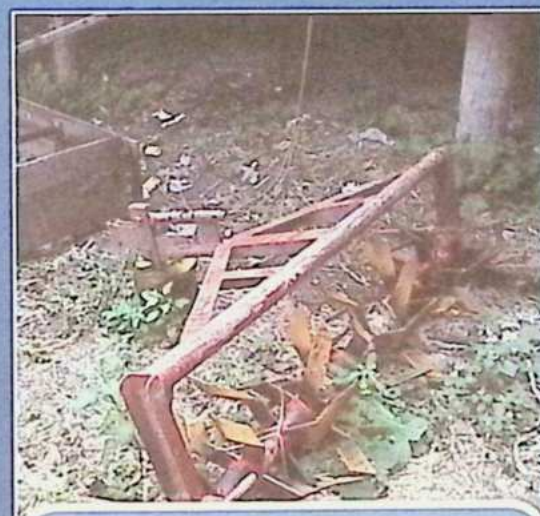
ลูกดวก มีใบสำหรับดวกจุดดินในนาขึ้นนา ทำให้ตอซึ่งข้าวปลูกเคล้าจมลงดิน ย่อยสลาย กลายเป็นปุ๋ย
